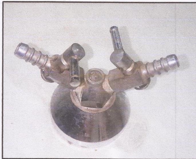
*Fig. 6.- Robinetes NO autorizados para la instalación de mecheros bunsen.*
